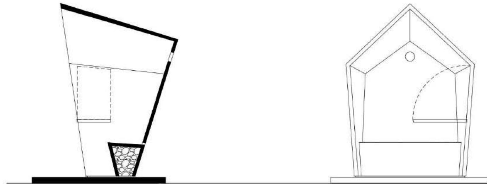
BOX in compensato marino sp 18 mm rivestito esternamente con fasciame di legno di recupero basamento circolare in CLS prefabbricato sp 12 cm diametro 240, compresa seduta in multistrato sp 24 mm
